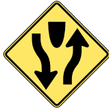
分支公路 (道路) 開始分隔
