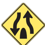
Carretera Dividida (Camino) Termina
